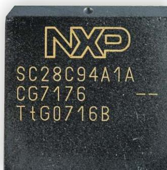
O circuito integrado J-NET-QUART deverá ser instalado na placa principal da central JUNO NET quando existe a necessidade de integrar uma impressora, interna ou externa, e quando a central é interligada com o software gráfico GFE, sistemas BMS externos ou MODBUS através de um interface J-NET-ADV-COMS da GFE.
